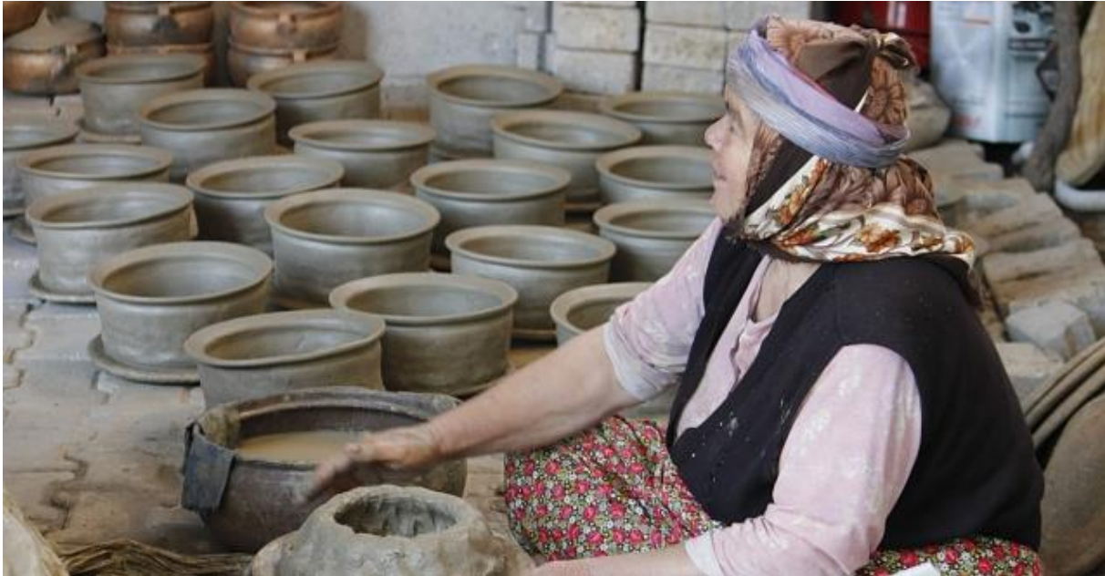
V vasi Gökeyüp (na območju geoparka Kula) slovijo po ročni izdelavi glinenih posod, ki jih izdelajo iz mešanice zdrobljenih vulkanskih kamnin in gline.
